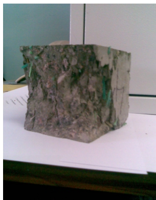
Образцы бетона конструкций после испытаний на прочность (слева - с добавлением фибры; справа - без фибры)
