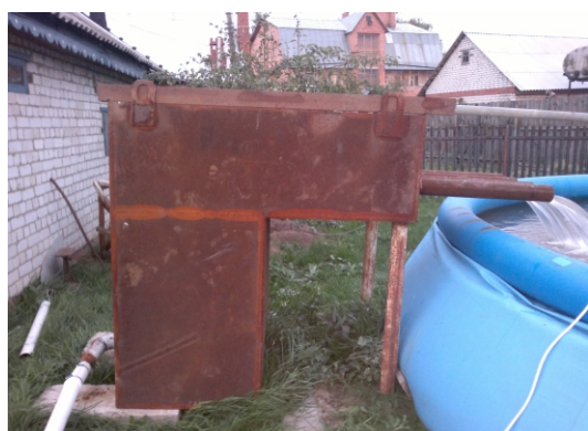
Установка для испытания на истираемость
