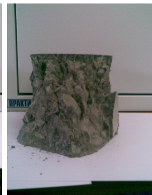
Образцы бетона конструкций после испытаний на прочность (слева - с добавлением фибры; справа - без фибры)
